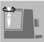
Visser le filtre dans le réservoir d'eau
